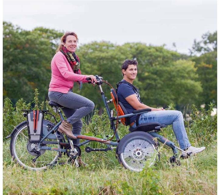
Das OPair ist eine wahre Wunderpackung: Spezialtandem in einem, schiebbarer Rollstuhl im nächsten Moment. Durch sein abkoppelbares Vorderteil ist es das flexibelste aller drei Pedder-Modelle.
